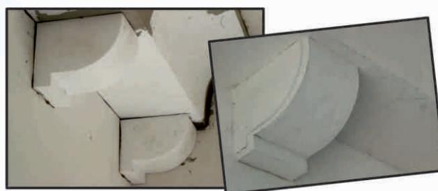
In foto un esempio di matrice per la realizzazione di una cornice in calcestruzzo
